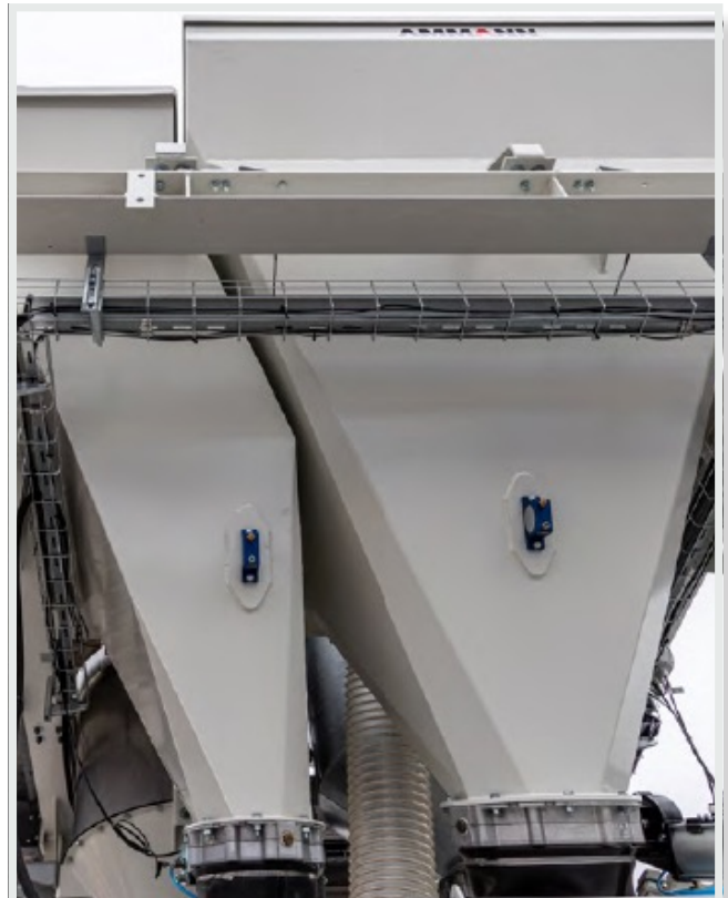
Waagenbühne mit Zementwaage und optionaler Silikawaage
