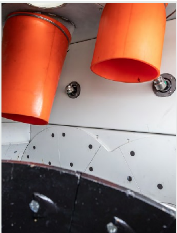
Mischer-Einlauf für Zement mit den Optionen Silika-Einlauf und Mischer-Reinigung.
