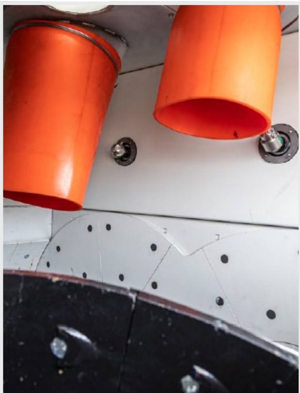
Entrée du ciment dans le malaxeur avec une entrée optionnelle pour l'introduction de silice ainsi qu'un système de nettoyage du malaxeur
