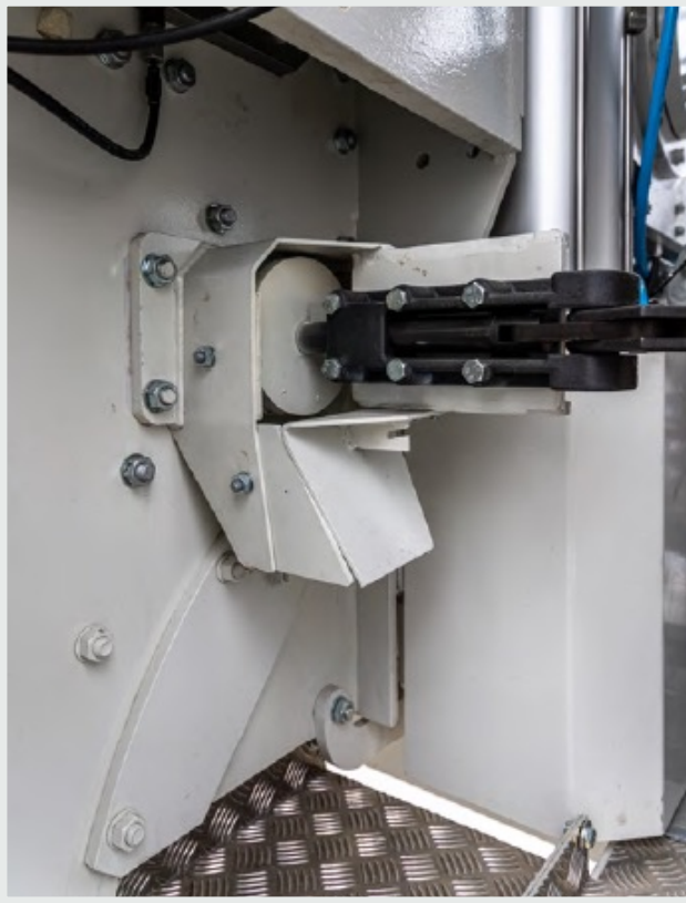
Entrée du ciment dans le malaxeur avec une entrée optionnelle pour l'introduction de silice ainsi qu'un système de nettoyage du malaxeur
