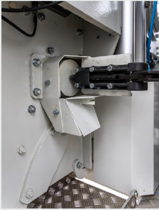
Entrada a la amasadora del cemento con la entrada opcional de sílice y de un sistema automatizado de limpieza de la amasadora
