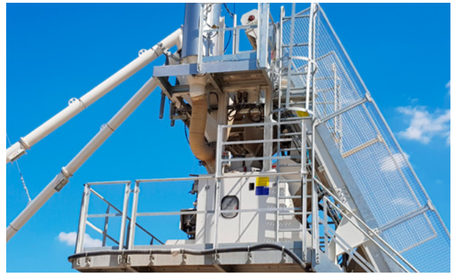
Las amplias plataformas de servicio y mantenimiento garantizan la mejor accesibilidad para el servicio.
