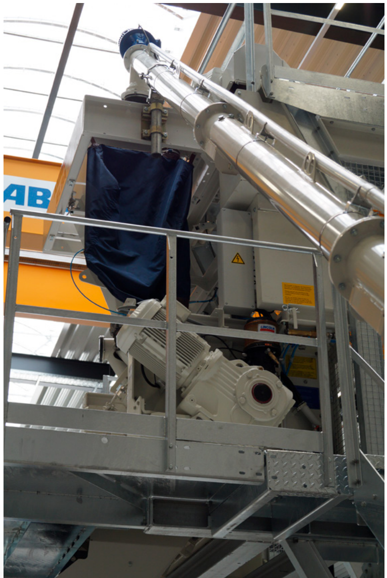
Dosificación de cemento directamente en la balanza de cemento, desempolvado central de la amasadora mediante airbag.
