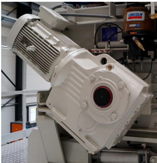
Amasadora CEM 500 S con lubricación central automática del eje y accionamiento manual directo para el mantenimiento.
