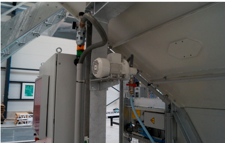
Dosificación opcional de aditivos mediante bomba dosificadora potente.
