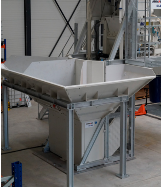
La tolva en estrella con un volumen de 4 x 2,5 m 3 para almacenamiento de áridos con compuertas de dosificación integradas.
