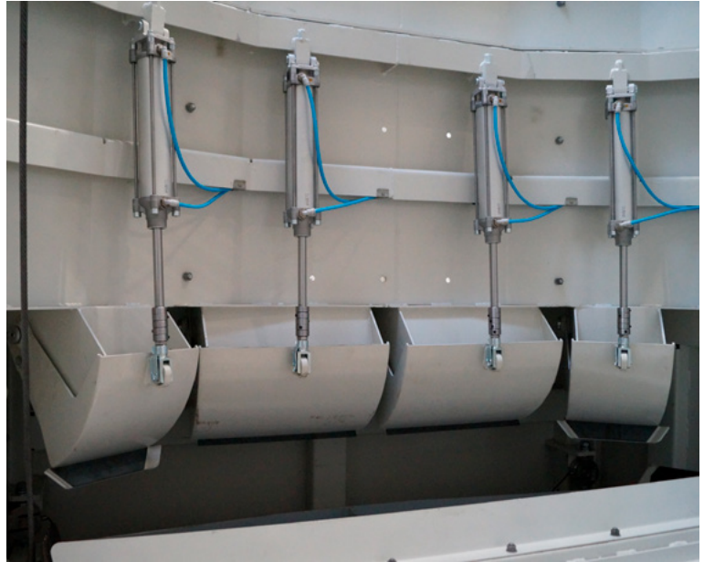
Compartimentos de dosificación con compuertas de dosificación neumáticas integradas y skip pesador de áridos con alcance de 1500 kg.
