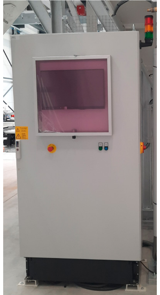
Visualización del estado mediante sistema de semáforo, funcionamiento mediante pantalla táctil, dosificación de aditivos en opción.
