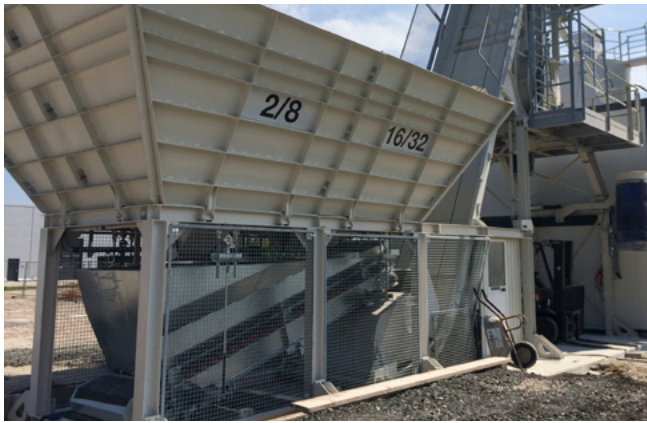
Tolvas de áridos compactas con cinta transportadora de pesaje integrada.
