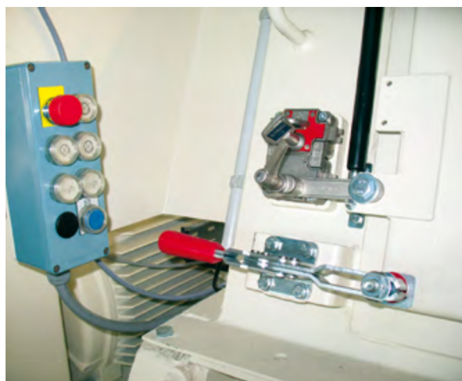
Le aperture di accesso al miscelatore sono come standard protette da un robusto sistema ausiliario a interblocco (in accordo alla norma EN 1088:2008).
