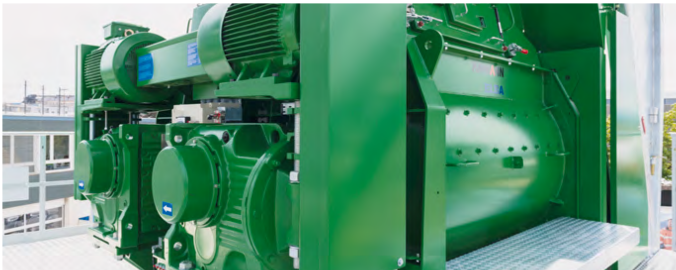
CEM 3000 T Elba con vista dal lato di azionamento. Azionamento con robusti motori elettrici, cinghie dentate e ingranaggi conici.
