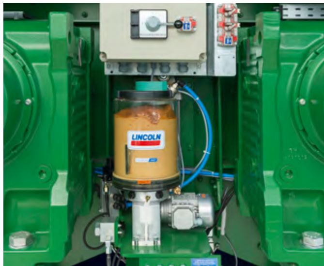
Dispositivo centralizzato di lubrificazione con controllo del flusso del grasso.
