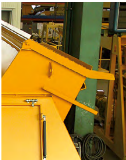
Uno sportello con nastri elastici di guarnizione chiude l'ingresso per gli additivi. (Opzione)
