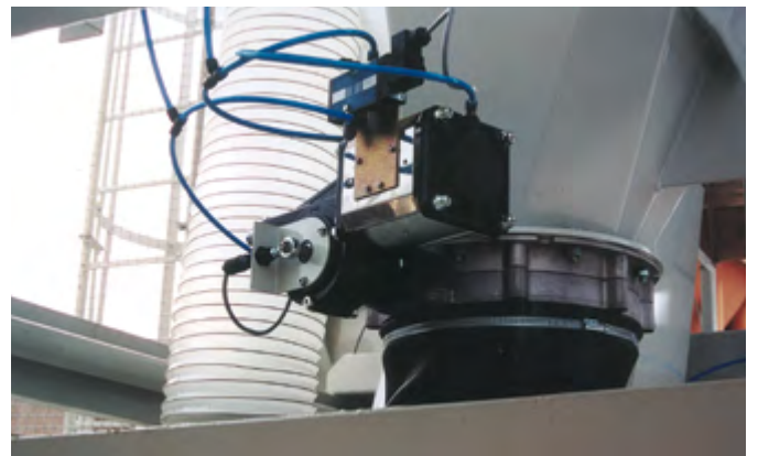
Se richiesto è possibile fornire il miscelatore con soluzioni di collegamento per aggiungere gli additivi e con tubo di sfiato da collegare alla bilancia cemento e filtro. Il canale rettangolare di ventilazione può alloggiare una videocamera con illuminazione. Ciò garantisce di controllare e monitor la procedura di miscelazione (solo in concomitanza con un impianto di aspirazione).
