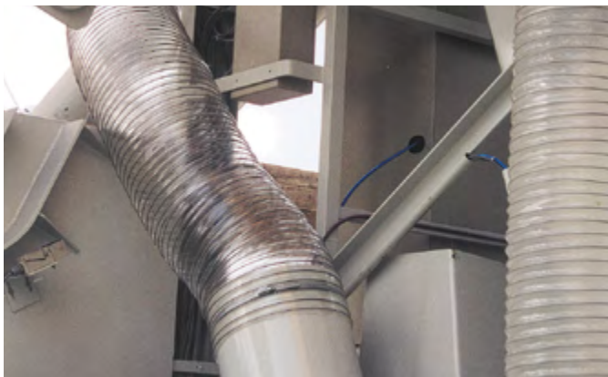
Se richiesto è possibile fornire il miscelatore con soluzioni di collegamento per aggiungere gli additivi e con tubo di sfiato da collegare alla bilancia cemento e filtro. Il canale rettangolare di ventilazione può alloggiare una videocamera con illuminazione. Ciò garantisce di controllare e monitor la procedura di miscelazione (solo in concomitanza con un impianto di aspirazione).
