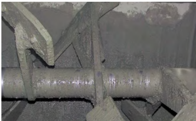
Se richiesto è possibile fornire il miscelatore con soluzioni di collegamento per aggiungere gli additivi e con tubo di sfiato da collegare alla bilancia cemento e filtro. Il canale rettangolare di ventilazione può alloggiare una videocamera con illuminazione. Ciò garantisce di controllare e monitor la procedura di miscelazione (solo in concomitanza con un impianto di aspirazione).
