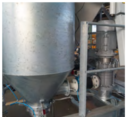
Per i miscelatori dal modello CEM 1000 S Elba al modello CEM 2500 S Elba è disponibile come opzione un impianto di pulizia. Il tubo di pulizia sul quale sono montati gli effusori è orientabile a 270 gradi. La pulizia può essere effettuata a scelta automaticamente o manualmente. Una pompa a più stadi preleva l'acqua per la pulizia ad es. dal contenitore della bilancia per l'acqua.
