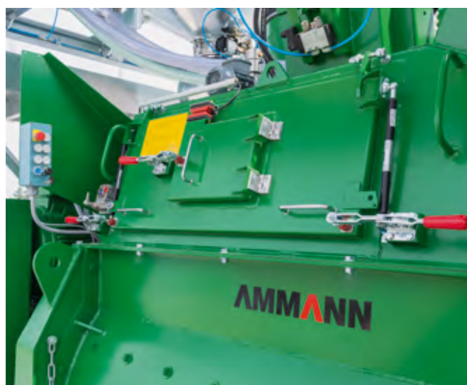
Controllo del processo di miscelazione attraverso lo sportello di apertura protetto da contatti accidentali (grandi aperture).
