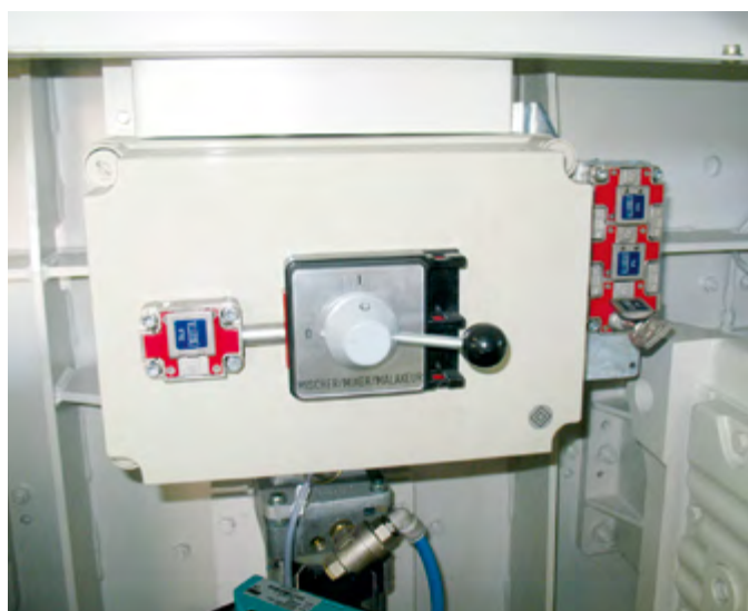
Le aperture di accesso al miscelatore sono come standard protette da un robusto sistema ausiliario a interblocco (in accordo alla norma EN 1088:2008).
