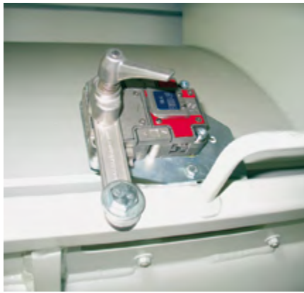
Le aperture di accesso al miscelatore sono come standard protette da un robusto sistema ausiliario a interblocco (in accordo alla norma EN 1088:2008).
