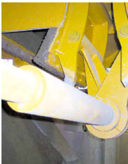
Dispositivo di chiusura aperto. Scarico quasi completo della miscela grazie ad un'innovativa soluzione di erogazione a più stadi.
