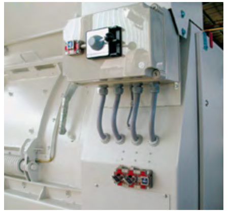
Le aperture di accesso al miscelatore sono come standard protette da un robusto sistema ausiliario a interblocco (in accordo alla norma EN 1088:2008).
