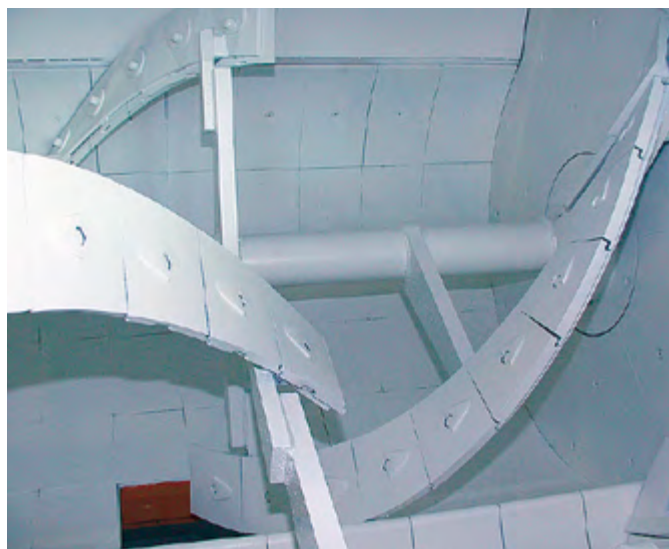
Rivestimento del vaglio con «piastre senza fori» brevettate.
