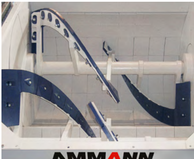
Le spirali Ammann Elba, un componente di provata efficacia, miscelano a fondo i materiali con movimento assiale e radiale.
