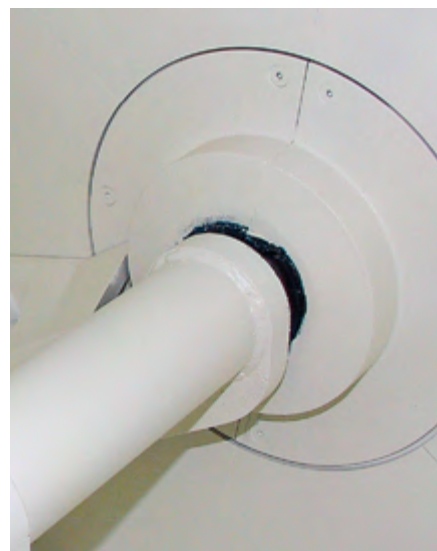
Accesso alla guarnizione a labirinto attraverso semi-gusci sul lato interno del miscelatore, che riducono al minimo la manutenzione in quanto non è necessario asportare i cuscinetti.
