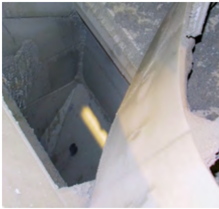
L'apertura di grandi dimensioni della chiusura del miscelatore permette uno scarico rapido.
