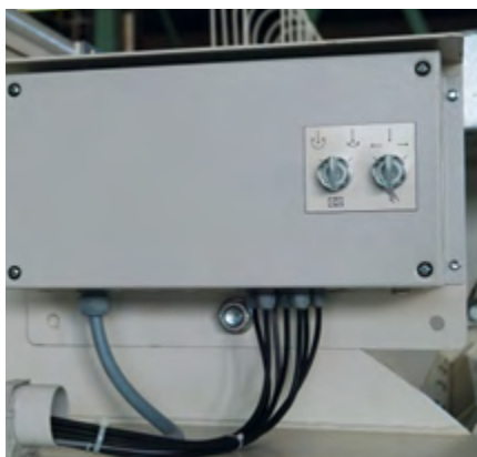
Per i miscelatori dal modello CEM 1000 S Elba al modello CEM 2500 S Elba è disponibile come opzione un impianto di pulizia. Il tubo di pulizia sul quale sono montati gli effusori è orientabile a 270 gradi. La pulizia può essere effettuata a scelta automaticamente o manualmente. Una pompa a più stadi preleva l'acqua per la pulizia ad es. dal contenitore della bilancia per l'acqua.
