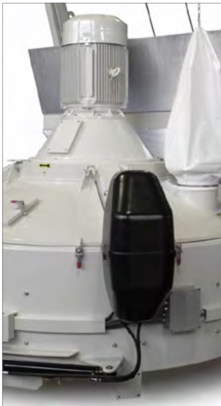
Hydraulischer Antrieb für den Verschluss.
