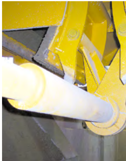
Verschluss geschlossen. Nahezu restlose Mischerentleerung durch neue mehrstufige Verschluss-technik. Betätigung über zuverlässige Pneumatikzylinder.
