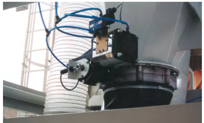
Der Mixer kann auf Wunsch mit Anschlüssen für die Einleitung von Zusatzmitteln und einem Entlüftungsschlauch zum Anschluss an Zementwaage und Filter ausgerüstet werden. Der rechteckige Belüftungskanal eignet sich zur Installation einer Videokamera mit Beleuchtung. Der Mischervorgang kann damit auf dem Monitor beobachtet werden (nur in Verbindung mit Absauganlage).
