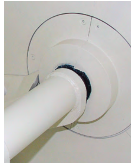
Zugang zur Labyrinthdichtung durch Halbschalen an der Mischer-Innenseite erleichtern die Wartung auf ein Minimum, ohne das Lager zu entfernen.
