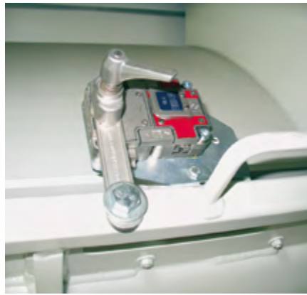
Mischer-Zugangsöffnungen standardmässig durch zusätzliches, robustes Schlüsseltransfersystem abgesichert (entsprechend EN 1088:2008).
