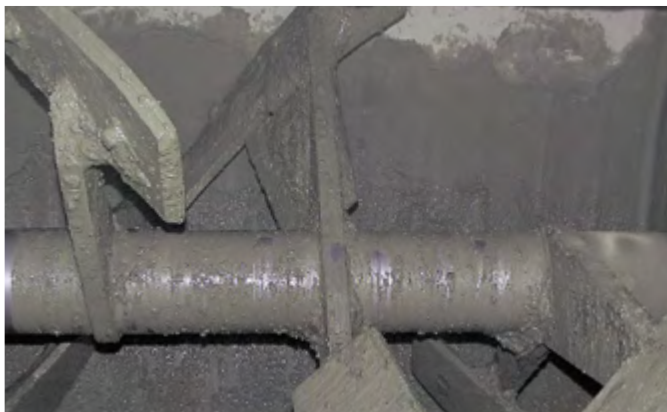
Der Mixer kann auf Wunsch mit Anschlüssen für die Einleitung von Zusatzmitteln und einem Entlüftungsschlauch zum Anschluss an Zementwaage und Filter ausgerüstet werden. Der rechteckige Belüftungskanal eignet sich zur Installation einer Videokamera mit Beleuchtung. Der Mischervorgang kann damit auf dem Monitor beobachtet werden (nur in Verbindung mit Absauganlage).
