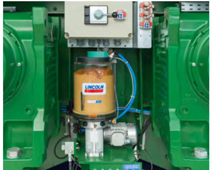
Zentrale Fettschmiereinrichtung mit Fettflussüberwachung.
