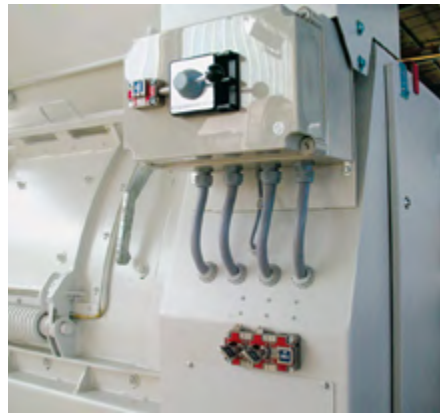
Mischer-Zugangsöffnungen standardmässig durch zusätzliches, robustes Schlüsseltransfersystem abgesichert (entsprechend EN 1088:2008).
