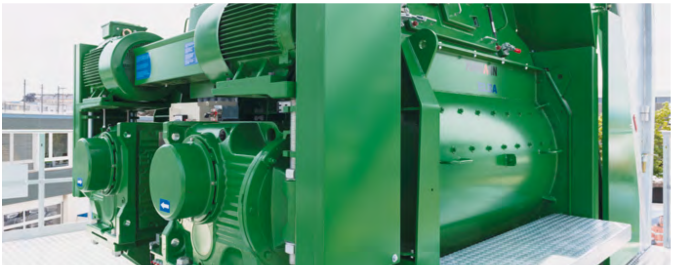
Antriebsseite CEM 3000 T Elba Antrieb durch robuste E-Motoren, Zahnriemen und Kegelradgetriebe.
