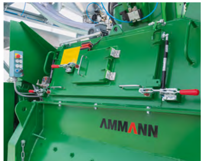
Beobachtung des Mischprozesses durch berührungsgeschützte Öffnungsklappe, grosse Reinigungsöffnungen.
