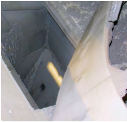
Die grosse Öffnung des Mischerverschlusses erlaubt schnelle Entleerung des Mixers.
