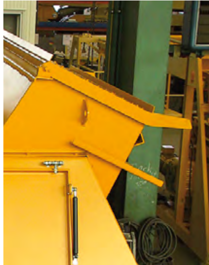
Eine Klappe mit elastischen Dichtungsbändern verschliesst den Zuschlageinlauf. (Option)
