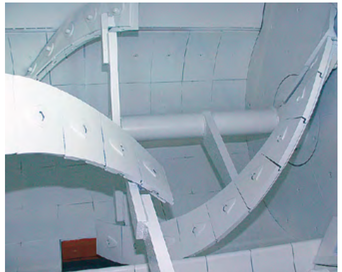
Trogauskleidung mit patentierter «lochloser Kachelung».
