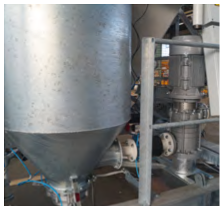
Für die Mixer CEM 1000 S Elba bis CEM 2500 S Elba steht optional eine Mischerreinigungsanlage zur Verfügung. Das düsenbestückte Reinigungsrohr lässt sich um 270 Grad schwenken. Die Reinigung erfolgt wahlweise automatisch oder handgesteuert. Eine Mehrstufenpumpe entnimmt das Reinigungswasser z. B. aus dem Behälter der Wasserwaage.
