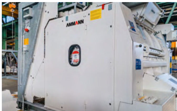
CEM 2000 S Elba installé sur plateforme de malaxage.
