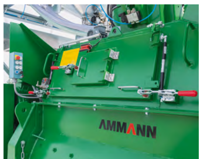
Trappe de maintenance du malaxeur protégée par un système de clé prisonnière (selon normes EN 12151 resp. EN 1088 / 2008).
