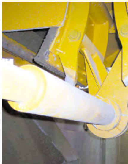
Trappe de vidange fermée Vidange par paliers quasi intégrale du malaxeur, grâce à une nouvelle technique de fermeture, actionnée par des vérins pneumatiques fiables.
