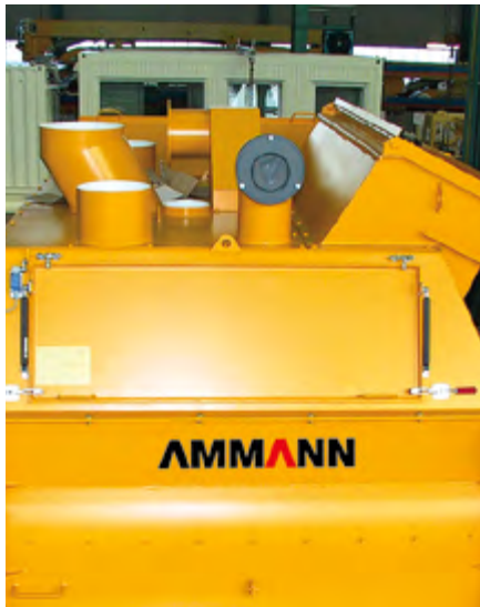
Nombreuses possibilités de connexion aux différents équipement de l'installation (bascules, dispositifs de dépoussiérage). (Option)
