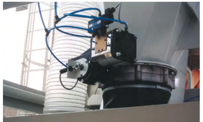
Le malaxeur peut être équipé en option de piquages pour l'arrivée d'adjuvants et d'un tuyau d'aération pour le raccordement à la bascule à ciment et à un filtre. La prise d'air rectangulaire convient parfaitement à l'installation d'une caméra vidéo avec un éclairage, permettant d'observer le processus de malaxage sur un monitor (seulement en liaison avec un dispositif d'aspiration).
