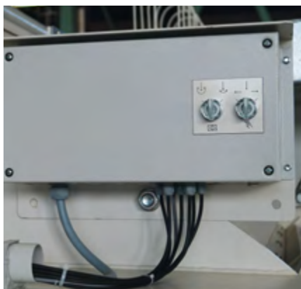
Un système de lavage du malaxeur peut être installé en option pour les malaxeurs de type CEM 1000 S Elba à CEM 2500 S Elba. Le tube de nettoyage équipé de buses oscille sur 270° par l'intermédiaire d'un moteur électrique. Le nettoyage peut se faire automatiquement ou être commandé manuellement. Une pompe à paliers va puiser l'eau de nettoyage par exemple dans la bascule à eau.
