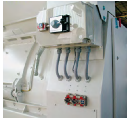
Trappe de maintenance du malaxeur protégée par un système de clé prisonnière (selon normes EN 1088:2008).
