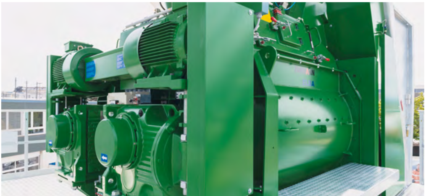
Entraînement CEM 3000 T Elba par 2 moteurs électriques de grande robustesse. Liaison à l'engrenage à pignons coniques par un système de courroie crantée.
