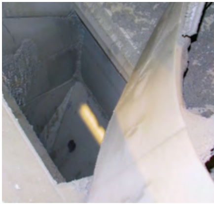
La grande ouverture de la trappe de vidange du malaxeur Ammann Elba permet sa vidange rapide.
