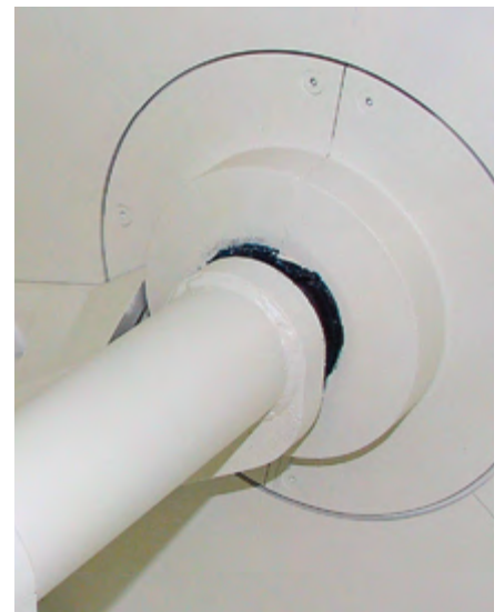
L'accès au joint labyrinthe par des demi-coquilles depuis l'intérieur du malaxeur facilite la maintenance et la réduit à un minimum, sans qu'il soit nécessaire de retirer le palier.
