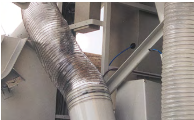
Le malaxeur peut être équipé en option de piquages pour l'arrivée d'adjuvants et d'un tuyau d'aération pour le raccordement à la bascule à ciment et à un filtre. La prise d'air rectangulaire convient parfaitement à l'installation d'une caméra vidéo avec un éclairage, permettant d'observer le processus de malaxage sur un monitor (seulement en liaison avec un dispositif d'aspiration).
