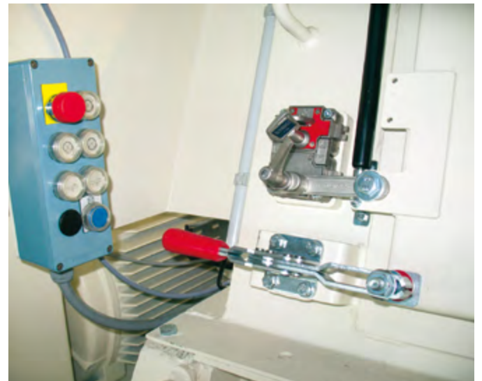
Trappe de maintenance du malaxeur protégée par un système de clé prisonnière (selon normes EN 12151 resp. EN 1088 / 2008).
