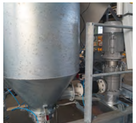
Un système de lavage du malaxeur peut être installé en option pour les malaxeurs de type CEM 1000 S Elba à CEM 2500 S Elba. Le tube de nettoyage équipé de buses oscille sur 270° par l'intermédiaire d'un moteur électrique. Le nettoyage peut se faire automatiquement ou être commandé manuellement. Une pompe à paliers va puiser l'eau de nettoyage par exemple dans la bascule à eau.
