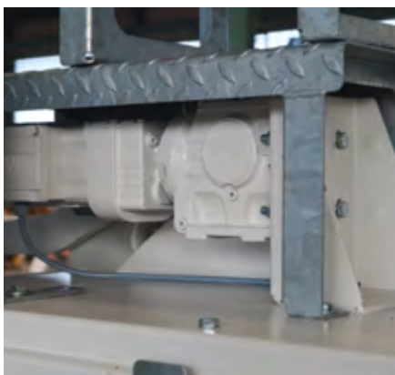
Un système de lavage du malaxeur peut être installé en option pour les malaxeurs de type CEM 1000 S Elba à CEM 2500 S Elba. Le tube de nettoyage équipé de buses oscille sur 270° par l'intermédiaire d'un moteur électrique. Le nettoyage peut se faire automatiquement ou être commandé manuellement. Une pompe à paliers va puiser l'eau de nettoyage par exemple dans la bascule à eau.
