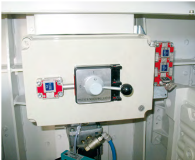
Trappe de maintenance du malaxeur protégée par un système de clé prisonnière (selon normes EN 12151 resp. EN 1088 / 2008).
