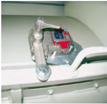
Trappe de maintenance du malaxeur protégée par un système de clé prisonnière (selon normes EN 1088:2008).
