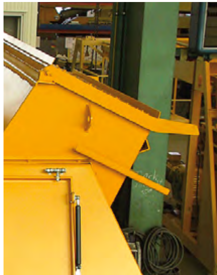
Une trappe avec joints d'étanchéité élastiques permet de fermer l'alimentation des agrégats. (Option)
