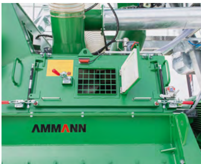
Observation du processus de malaxage grâce à une trappe de visite protégée.
