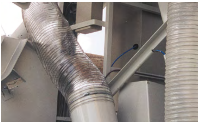
Si se desea, la mezcladora puede equiparse con conexiones para la alimentación de aditivos y una manguera de purga de aire para conectar a una báscula de cemento y filtro. El canal de ventilación en ángulo recto es apropiado para la instalación de una cámara de vídeo con iluminación. El proceso de mezcla puede vigilarse así desde el monitor (solo en conexión con la instalación de aspiración).
