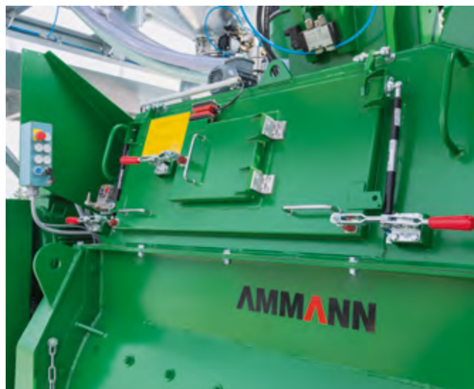
Observación del proceso de mezcla a través de compuertas de apertura protegidas contra el contacto, grandes aperturas de limpieza.
