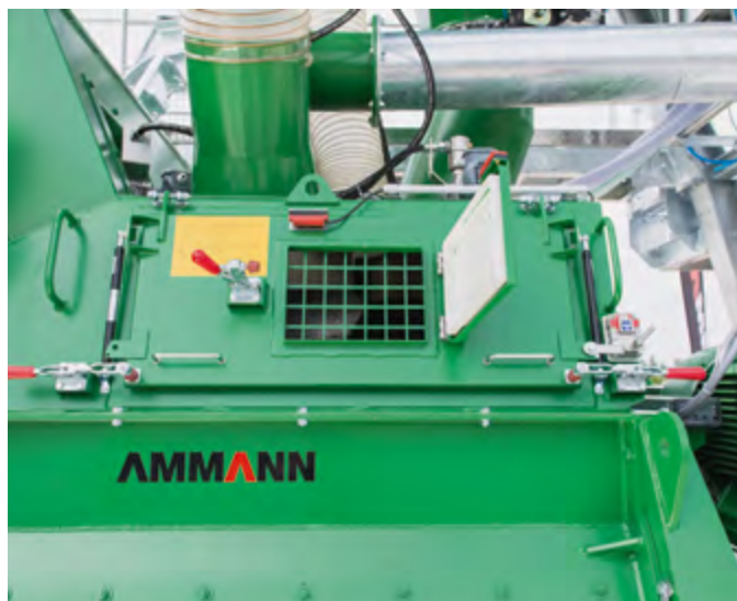
Observación del proceso de mezcla a través de compuertas de apertura protegidas contra el contacto, grandes aperturas de limpieza.
