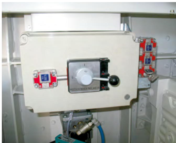
Las aperturas de acceso de la mezcladora están aseguradas de manera estándar por un robusto sistema de bloqueo por llaves adicional (según EN 1088 2008).
