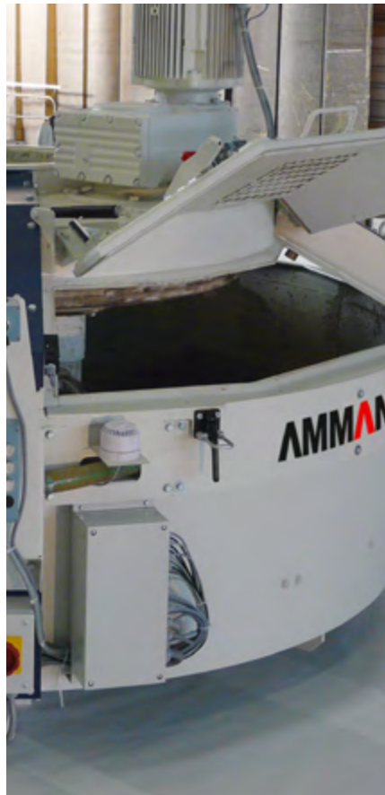
Grandes aperturas de limpieza. Compuertas vigiladas y fáciles de abrir.
