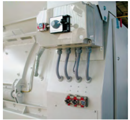
Las aperturas de acceso de la mezcladora están aseguradas de manera estándar por un robusto sistema de bloqueo por llaves adicional (según EN 1088 2008).
