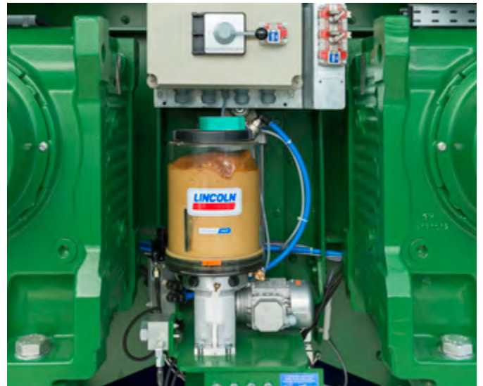
Dispositivo de lubricación central con vigilancia de flujo de grasa.
