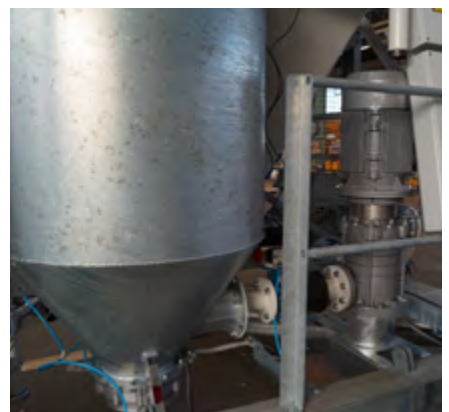
Para la mezcladora CEM 1000 S Elba y hasta la CEM 2500 S Elba, hay disponible de forma opcional una instalación de limpieza de la mezcladora. El tubo de limpieza con toberas se puede girar 270 grados. La limpieza se realiza de forma automática o controlada manualmente a elección. Una bomba de varios niveles saca el agua de limpieza de, por ejemplo, el depósito del nivel de agua.
