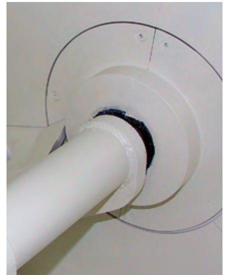
El acceso a la junta laberíntica a través de semicopas al interior de la mezcladora facilitan el mantenimiento al mínimo sin retirar el cojinete.
