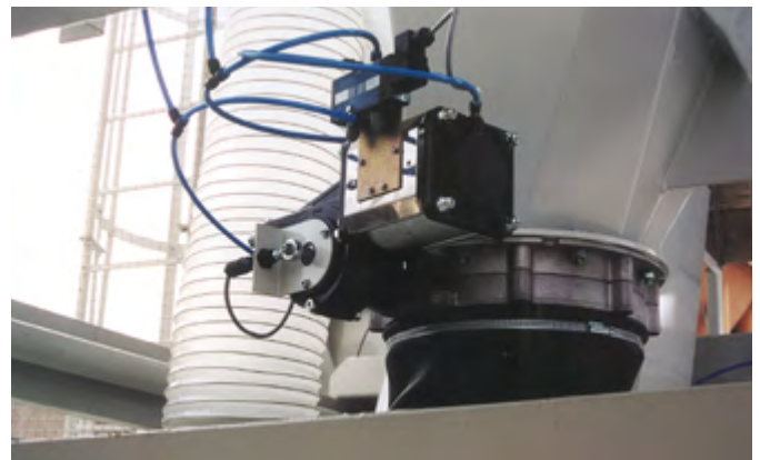
Si se desea, la mezcladora puede equiparse con conexiones para la alimentación de aditivos y una manguera de purga de aire para conectar a una báscula de cemento y filtro. El canal de ventilación en ángulo recto es apropiado para la instalación de una cámara de vídeo con iluminación. El proceso de mezcla puede vigilarse así desde el monitor (solo en conexión con la instalación de aspiración).
