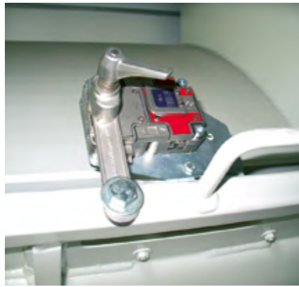
Las aperturas de acceso de la mezcladora están aseguradas de manera estándar por un robusto sistema de bloqueo por llaves adicional (según EN 1088 2008).
