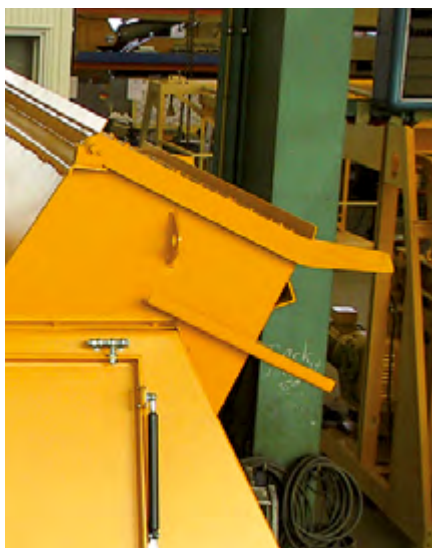
Una compuerta con bandas de estanqueidad elásticas cierra la entrada de aditivos. (Opción)
