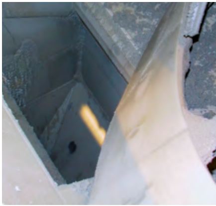
La apertura grande del cierre de la mezcladora permite un vaciado rápido de la mezcladora.
