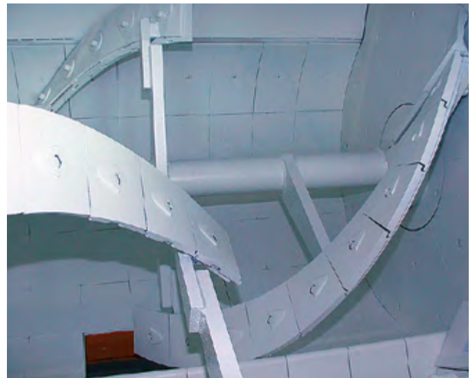
Revestimiento de cuba con «recubrimiento sin agujeros» patentado.
