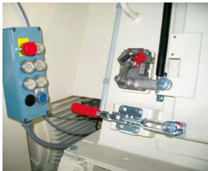
Las aperturas de acceso de la mezcladora están aseguradas de manera estándar por un robusto sistema de bloqueo por llaves adicional (según EN 1088 2008).
