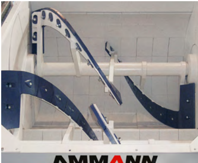
El proceso de mezcla intensivo consigue al mismo tiempo un movimiento axial y radial gracias a los probados espirales de mezcla Elba.
