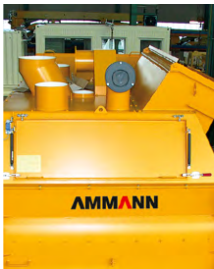
Amplias posibilidades de conexión a dispositivos tecnológicos (básculas, dispositivos de extracción de polvo, etc.) (Opción)
