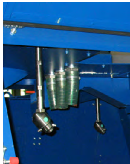
Disposición de las toberas de limpieza y la unidad de aditivos. (Opción)
