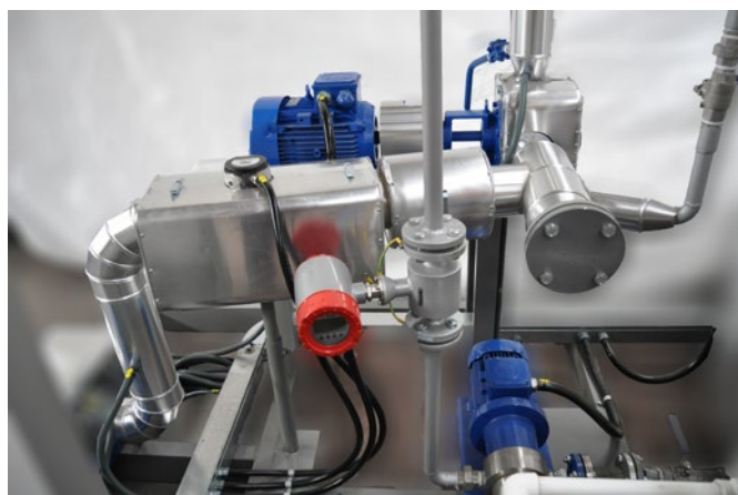
Mixage bitume – EAE.
