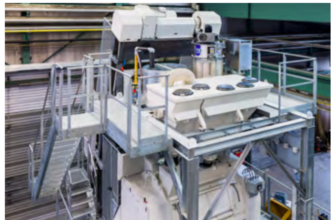
Ottima accessibilità della piattaforma di elevatore e bilancia sul CBS 105 SL Elba.
