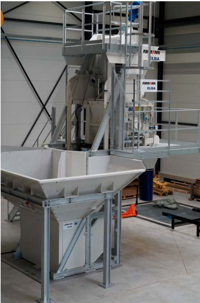
CFS 30 SL Elba avec l'option, passerelle au niveau du treuil de skip.
