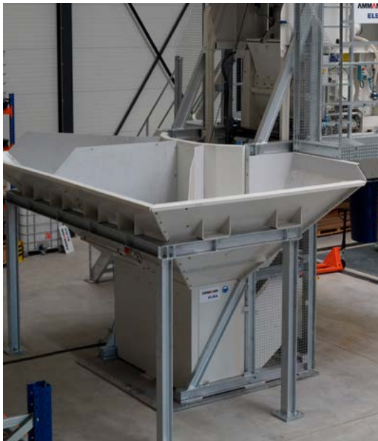
Trémie de poche d'un volume de 4 \times 2.5 \text{ m}^3 pour le stockage des agrégats avec le système de dosage intégré.
