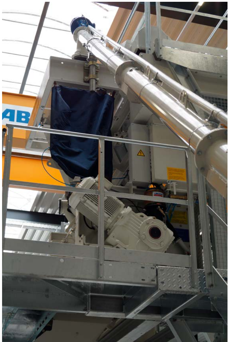
Dosage du ciment directement dans la bascule à liant, décompression du malaxeur par airbag.
