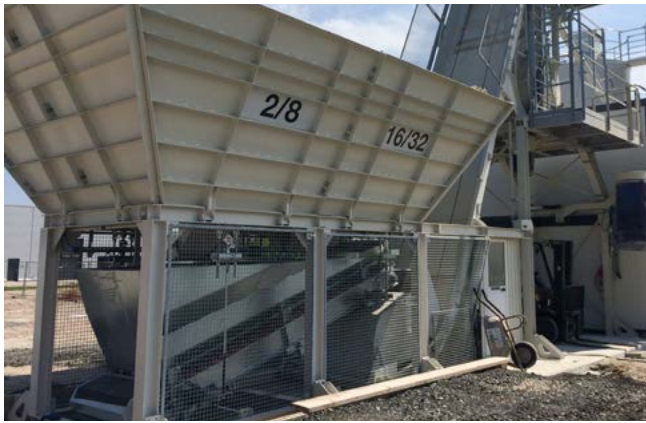
Trémie agrégats compacte avec le tapis peseur intégré.
