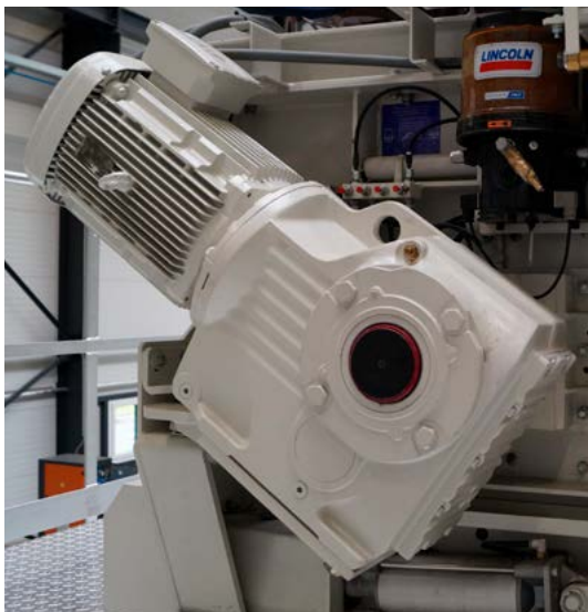
Mischer CEM 500 S mit automatischer Mischerzentralschmierung und wartungsfreiem Direktantrieb.
