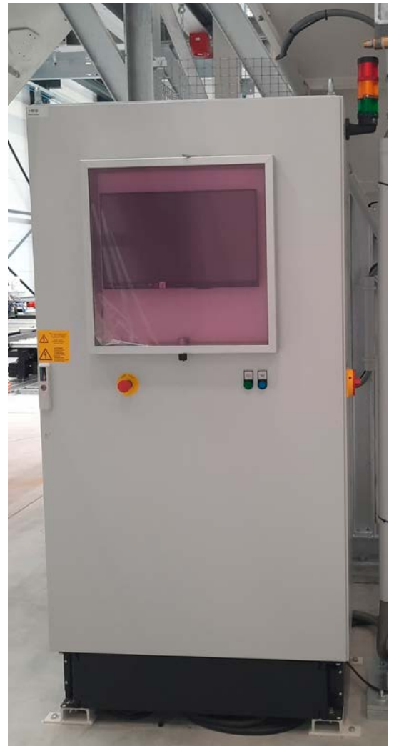
Zustandsanzeige über Ampelanlage, Touchscreen-Bedienung, optional Zusatzmitteldosierung.
