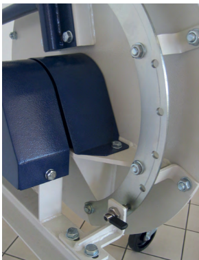
Wartungsfreie Lager. Arretierbares Schwenken.
