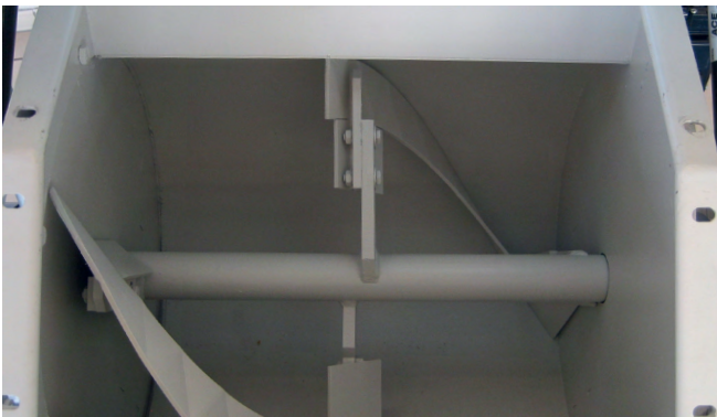
Innenansicht mit auswechselbarem Mischwerkzeug.
