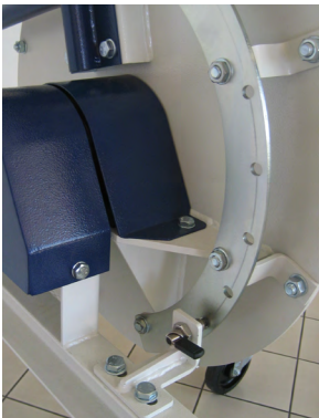
Paliers libres de maintenance. Basculement avec dispositif d'arrêt.
