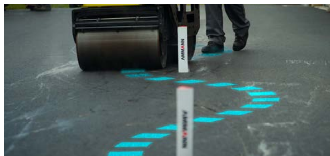
Ručně vedený válec ARW 65-S s úhlem natočení 15°
